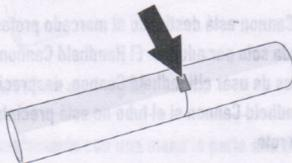
Abb. 2 Kontrollieren Sie, ob das Siegel intakt ist
